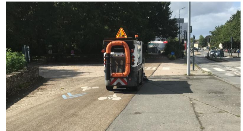
Balayeuse de voirie adaptée pour l'entretien des pistes cyclables sur le réseau express vélo à Rennes (35). Photo : BL évolution
